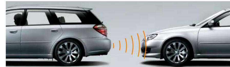
**90** Ultraschall Einparkhilfe mit 4 Sensoren für hinten, Ultraschall Zusatzsensor (2 oder 4 Stück notwendig) zur Erweiterung von 2470 für vorne ★ N
